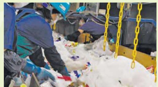
集められた容器包装プラスチックは、工場に運ばれたあと、コンベヤにのせて、人の手で選別します。ここでは、汚れたプラスチックやプラマークのついていない製品を除去します。
