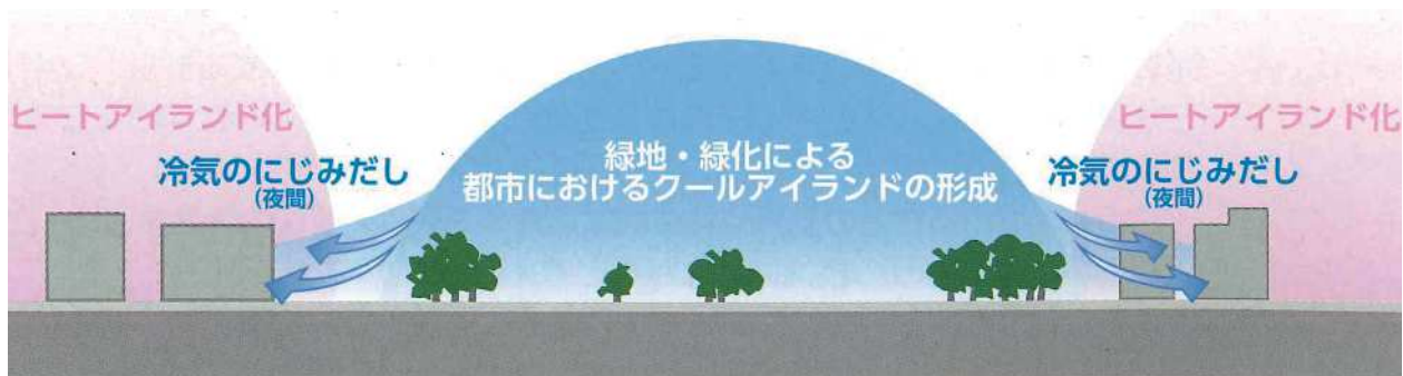
図 4-3 冷たい空気のにじみだし効果 出典：国土交通省パンフレットをもとに作成
