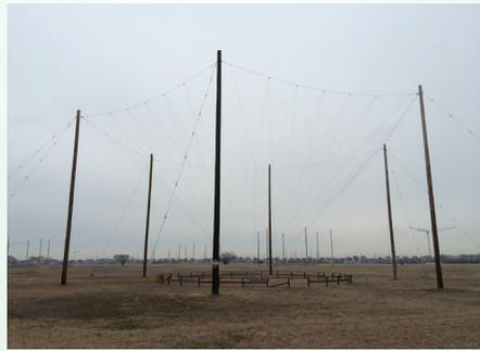
**Hoba アンテナ**：通常使用しているコニカルモノポールアンテナとHTOアンテナの機能を併せ持つ、無指向性のアンテナ。2 基
